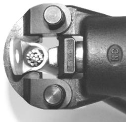
11. パワーユニットのスイッチを押して、ラムを前進させます。ポンチが端子を圧着し、受ダイスとポンチが接触しますが(200mm<sup>2</sup>の場合は接触しない)、そのままパワーユニットを動作させてください。圧力規制弁が作動する音が『ポン』と聞こえたら、圧着完了です。またこの時、ラム部に赤いラインが見えているか確認してください。赤いラインが見えていれば正常に圧着できています。
