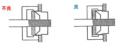
打抜きは完了しているが抜き屑の取り除きが容易でない
