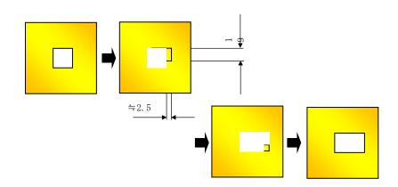
③ 拡大ポンチの場合、下穴とポンチ・ダイスの位置関係(ダイスの平面)の確認とケガキ線の併用でより正確できれいな角穴が得られます。
