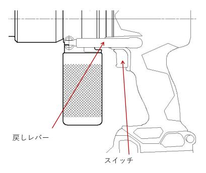
スイッチの引込み量により、無段階にモータの回転数が変ります。パンチの穴あけ位置の確認など、低速でラムを前進させる際にご利用ください。またスイッチをはなすとブレーキがかかり、モータはすぐに止まりますので、位置決めが容易にできます。スイッチの引込み量がわずかなときは「ピー」という音が発生します。これはモータのうなり音ですので、工具本体の異常ではありません。
